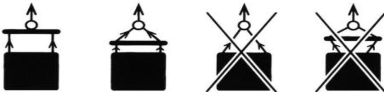
Figure #6 : La manutention correcte des micro stations BioKlar® ULTRA BKU10eh
