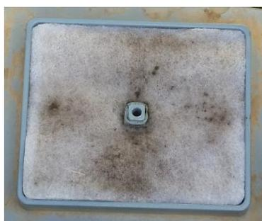
Figure #15 : Filtre à air à nettoyer
